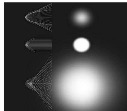
**Posizione nel fuoco :** posizionando la fonte di luce nel fuoco della parabola, la luce riflessa dal fondo produrrà fasci di luce esattamente paralleli. In questa posizione verrà generata la massima efficienza di uscita. Esattamente come un canonico Soft Box Parabolico.
